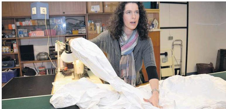
Je nach Größe des zu schützenden Roboters werden schon mal mehr als 20 Quadratmeter Schutzhülle vernäht. Die Prototypen für die verschiedensten Schutzhüllen entwickelt Andrea Ammerich-Geier zu Hause in einer kleinen Werkstatt. Fotos: Yvonne Heyer
